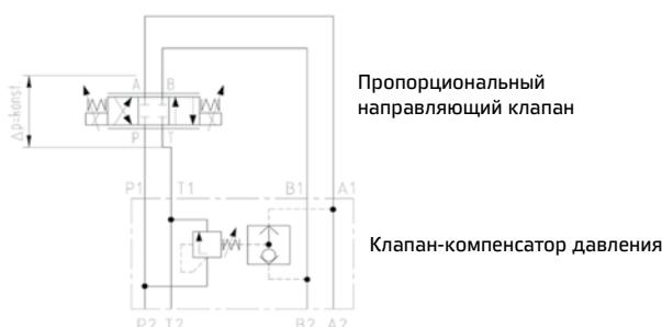
З-линейный клапан-компенсатор давления прямого действия модульной версии с монтажной поверхностью согласно стандартам CETOP и ISO. Его функция заключается в поддержании перепадов давления DP между линиями Р и А или В. Как правило, используется вместе с направляющими пропорциональными клапанами для регулировки потока независимо от изменений давления. Выбор давления управления в линиях А и В осуществляется автоматически обратным клапаном, встроенным в клапан-компенсатор.
